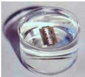
Bei einem stabilem Gleichgewicht der Flüssigkeit ist die potentielle Energie, zu der auch die Oberflächenspannung zählt, sehr gering. Die Oberflächenenergie ist dann sehr gering, wenn sich möglichst wenig Moleküle an der Oberfläche befinden, die Oberfläche also minimiert wurde.
