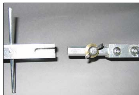
Bild 10: Einzelheit des Boom-Stecksystems von DJ9YW, das ein Zerlegen der Yagi in vier Einzelstücke erlaubt.
