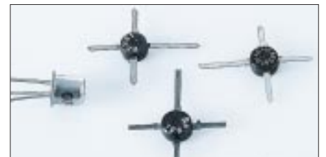
Bild 4: Links ein Germanium-Transistor aus den siebziger Jahren, daneben rauscharme Dual-Gate-FET BF981 aus den Achtzigern, wie sie für 2-m-Vorverstärker auch heute noch völlig ausreichend sind.
