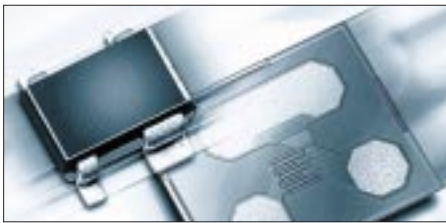
Bild 5: Der 1999 von Infineon entwickelte BF620 rauscht auf 1,8 GHz mit 0,65 dB und weist bei 21 dB Verstärkung einen IP3 von +10 dBm auf. Werkfoto
