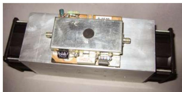
**Bild 7:** Kühlkörper mit PA-Modul auf einer 5-mm-Cu-Platte und beidseitiger Lüftermontage
