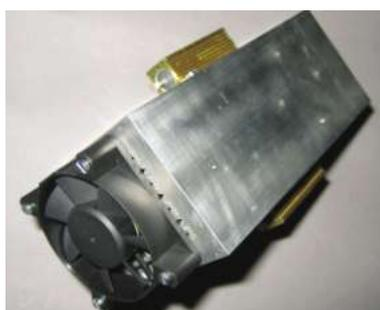
**Bild 6:** Kühlkörper-Messaufbau mit zwei 50-W-Leistungswiderständen
