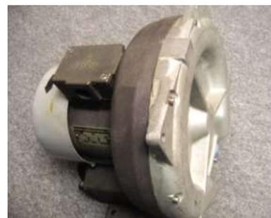
**Bild 3:** Drucksteifer Hochleistungs-Ringverdichter mit 450 W
