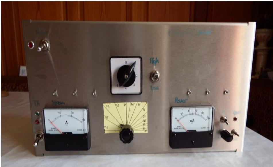
In der Mitte oben der Drehschalter für die Ausgangsleistung in 6 Stufen, unten Mitte der VFO 470 – 480 kHz.
