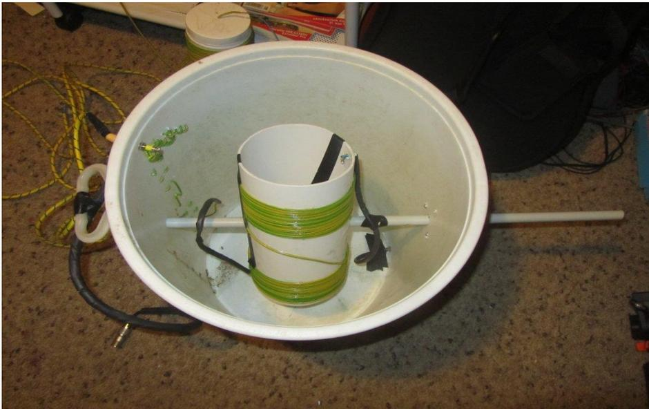
Das Variometer von unten mit Sicht auf die drehbare Spule.
