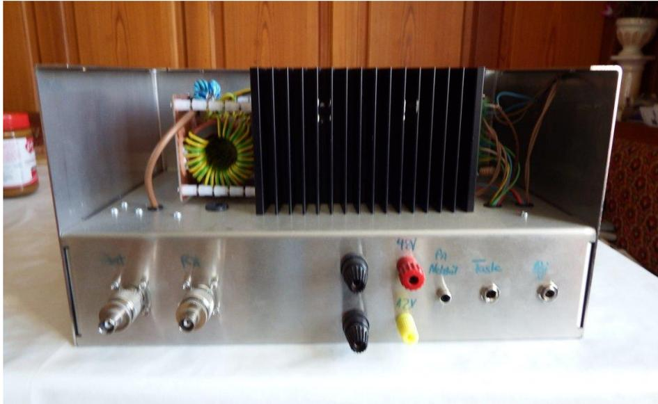
Links: Antenne, RX, oben 48V, unten 12V, Ein Netzteil 48V, Taste, Digi.
