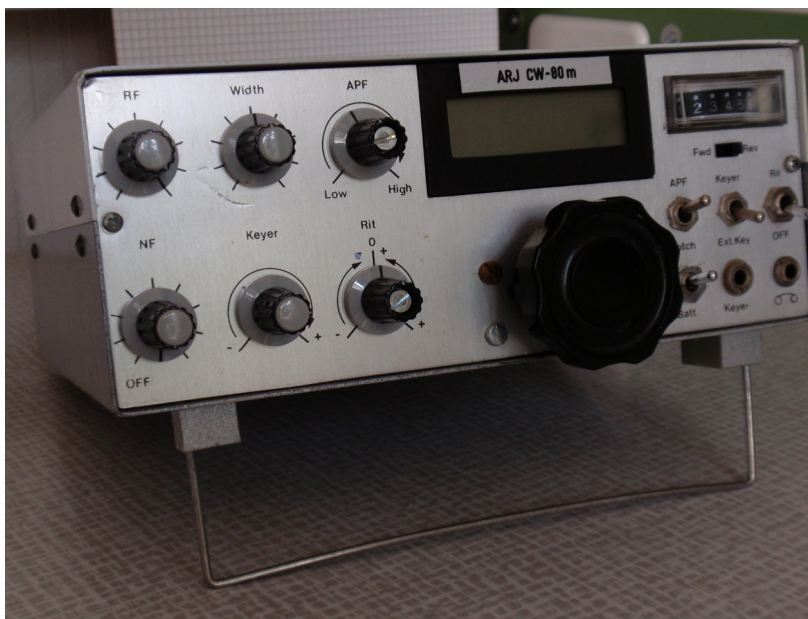
80m CW TRX nach HB9ARJ, gebaut von HB9CUK
