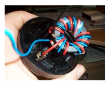
Nun noch die PL-Anschlussdrähte mit dem UNUN verlöten und die Antenne kann zusammengeschraubt werden.
